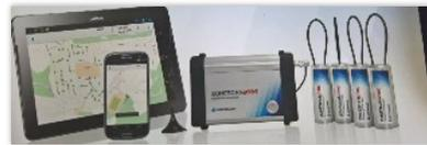
Le principe consiste à placer des capteurs sur différentes zones du réseau et effectuer des relevés réguliers avec un véhicule pour récupérer les informations.
